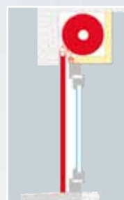
Pose dans coffre existant enroulement intérieur
