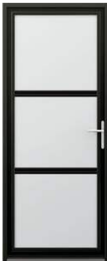
RIME Ouvrant apparent Traverses intermédiaires de 51 mm Double vitrage feuilleté dépoli Ud 2,0 W/m 2 .K - 35 dB
