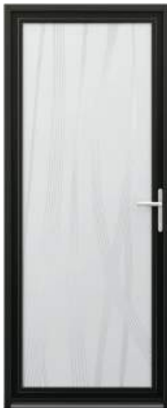
BRISE Ouvrant apparent Triple vitrage feuilleté Motif sablé cristallisé Ud 1,4 W/m 2 .K - 34 dB
